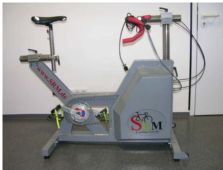
Abb. 2.2. SRM-Fahrradergometer der Firma Schoberer
