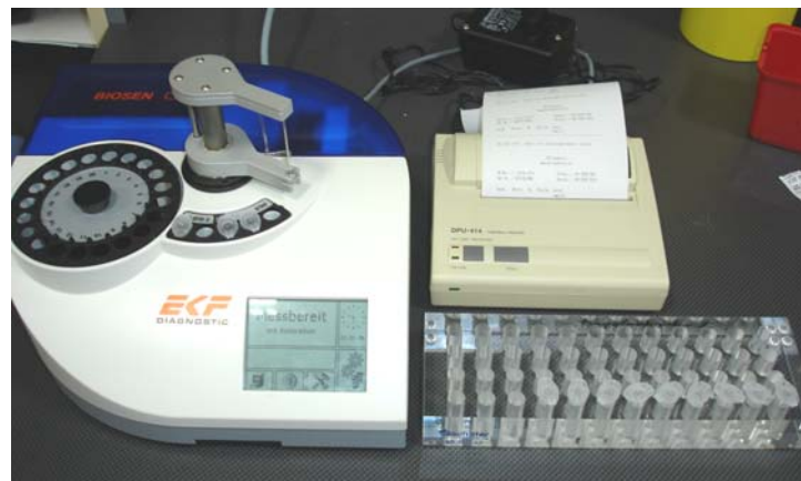
Abbildung 11: Laktatanalysegerät „BIOSEN C_line“ ® der Firma EKF-diagnostic GmbH mit portablem Drucker und Laktatprobenhalter.
